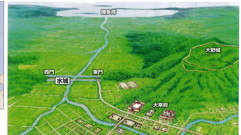
大宰府の守り「水城」 博多湾から上陸した敵をくい止め、大宰府を防御するために築かれた水城。水城は土壁で、延長約1km、幅が約50mあり、内側に水をたたえていた。現在も一部が残っている。→P.64
